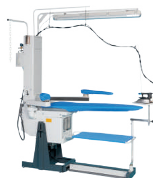
FIT1-WC Zaawansowany stół prasowniczy z odsysaniem i nadmuchem blatu, (koniec z lewej) bez bojlera (wymaga przyłącza zewnętrznej pary)
