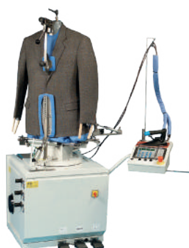
FFT-WC Multi-finiszier zaawansowany manekin formujący do marynarek (parowanie, naprężanie) z lekkim żelazkiem parowym
